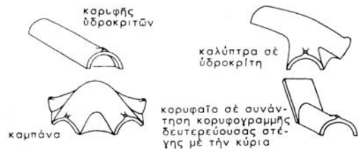
πιν. 112 (πάνω): Ενδεικτικά παραδείγματα ειδικών τύπων απολήξεων κορφιάδων
